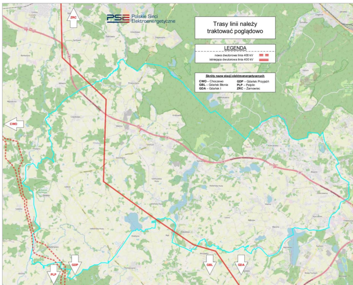
Rysunek 25. Schemat sieci przesyłowej na obszarze Gminy Szemud - plan źródło: Polskie Sieci Elektroenergetyczne S.A.
